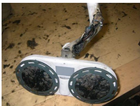
写真3 電動モップの焼損状況 （入力電圧 7.4V）
