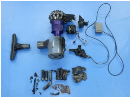
写真1 コードレス掃除機の 焼損状況
