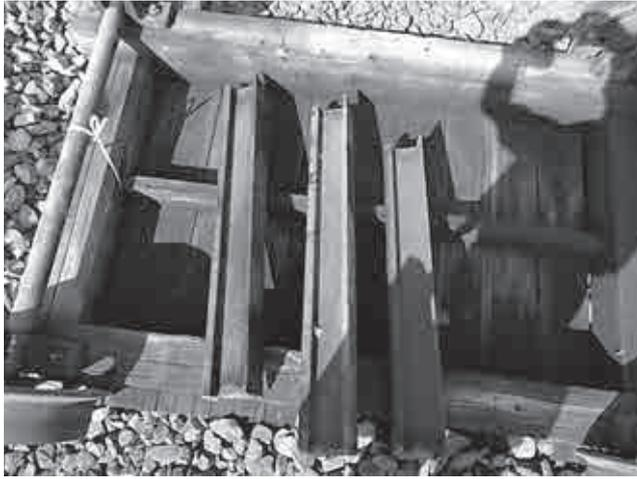
資料10 客車庫解体作業で見つかった3種類のレール(左からポーランド製=1926年の刻印、ベルギー製=1925年の刻印、イギリス製レール ※ 同種のレールから1870年代の製造と思われる)
