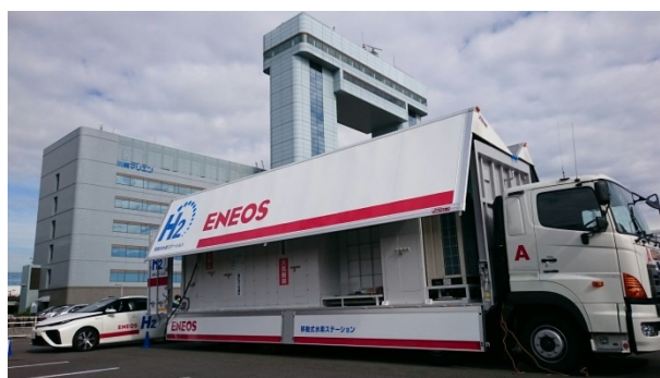
移動式水素ステーション （JX エネルギー(株)HP より）
