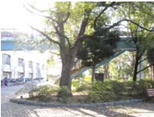
歩道橋の脚により動線・視線が遮られている(要点①)
