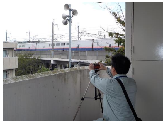
■ 新幹線鉄道騒音測定の様子
