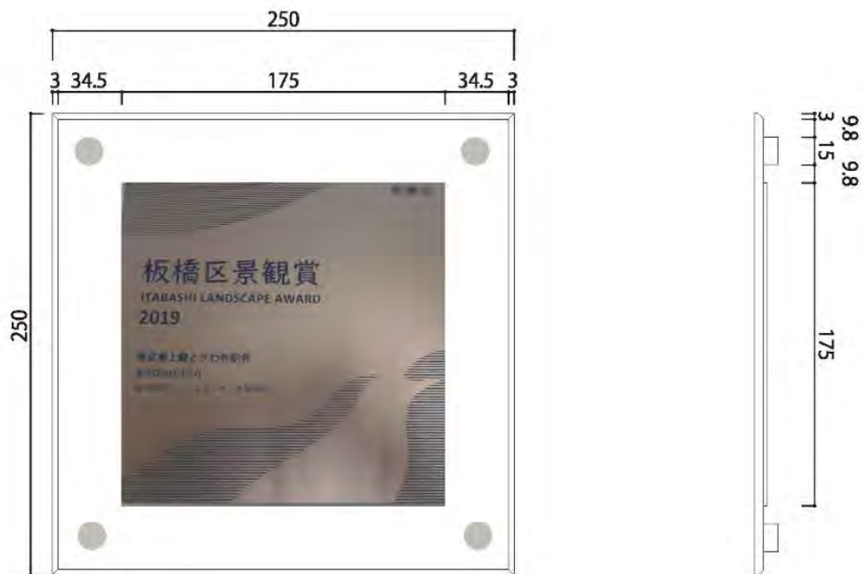
「景観賞受賞プレート」 w250×h250 (Scale1/2) 仕様：景観賞受賞プレート (SUS プレート・両面テープボンド併用接着) 下地アクリル (透明アクリル5t・テーパー 3mm 磨き加工) + 化粧ビスキャップφ=15mm (SUSHL 仕上げ)
