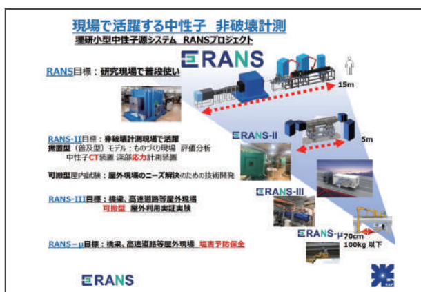
図1 「いつでも、どこでも中性子線利用」現場で活躍する理研小型中性子源システムRANS。研究現場でRANS、非破壊検査現場等でRANS-II、橋梁や高速道路現場でRANS-III、塩害予防保全に橋梁床版裏を非破壊でRANS- \mu 。
