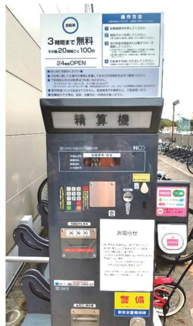
写真：非接触ICに対応した精算機
