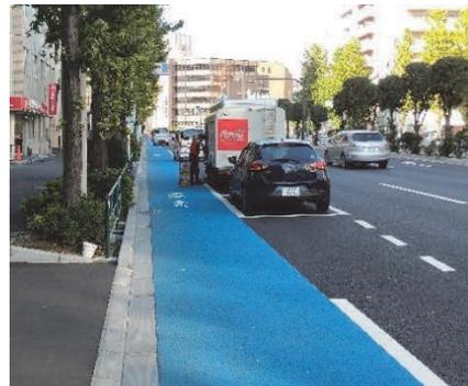
写真：自転車通行帯の右側に駐車スペースが設置された例（文京区内）
