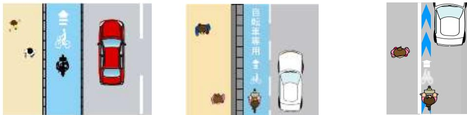
A) 自転車道 (幅員1.5m~2.0m以上)    B) 自転車専用通行帯 (幅員1.0m~1.5m以上)    C) 矢羽根型表示(車道混在) (幅員0.75m~1.0m以上)
