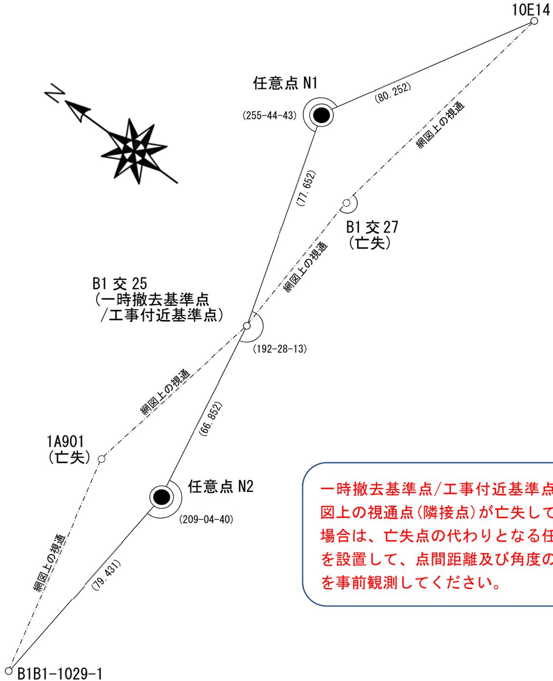
一時撤去基準点/工事付近基準点の網図上の視通点(隣接点)が亡失している場合は、亡失点の代わりとなる任意点を設置して、点間距離及び角度の数値を事前観測してください。
