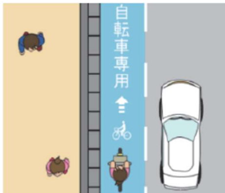
B) 自転車専用通行帯 (幅員 1.0m ~ 1.5m以上)
