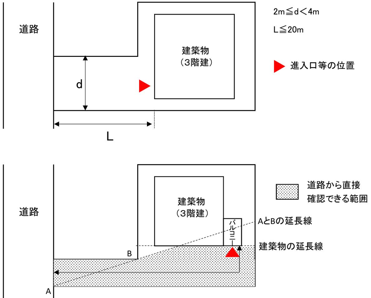
「AとBの延長線」と「建築物の延長線」で囲まれた範囲が、道路から直接確認できる範囲とする。
