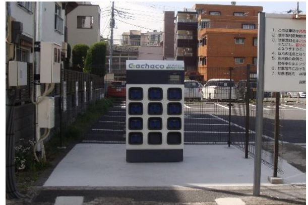
■バッテリー交換ステーション
