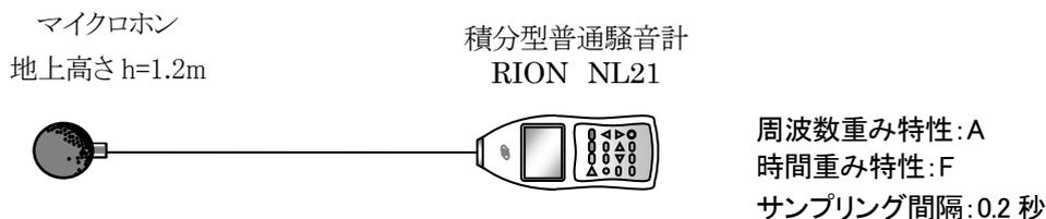
図 2.3 測定機器の構成図(騒音レベル)
