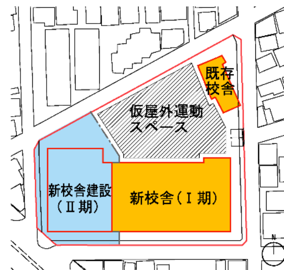
STEP3 新校舎（Ⅱ期）工事
