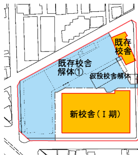
STEP2 既存校舎解体①
