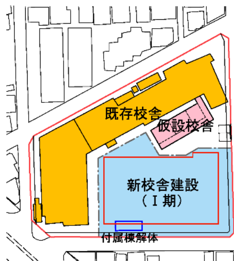
STEP1 新校舎（Ⅰ期）工事
