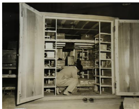
ガイガー・ミュラー計数管式宇宙線計（宇宙線の検出や計数ができ、粒子の飛来方向まで観測することができる装置）を研究員が操作している様子です。《図版2-8》
