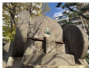
『圧磨機圧輪記念碑』 ベルギー産の火薬圧摩機で、 硫黄、硝石、木炭を粉碎して 黒色火薬を製造していました。 （所在：加賀西公園）
