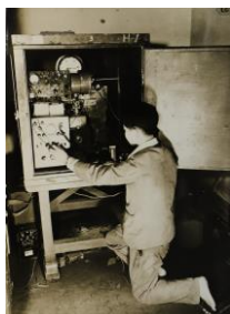
仁科型電離箱で宇宙線強度の測定を行っていました。《図2-6》
