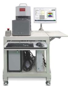
超高精度非接触レンズ中心厚測定機
