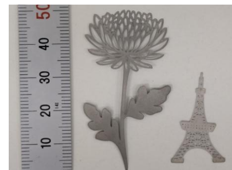
本手法で作製した薄型・小型製品 (厚さ：約150 \mu\text{m} 、調整可能)
