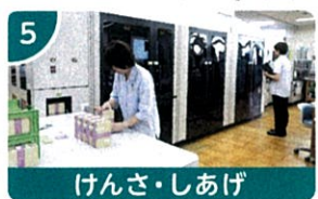
5 けんさ・しあげ 機械で1枚ずつ検査し、1000枚ずつの束に仕上げます。
